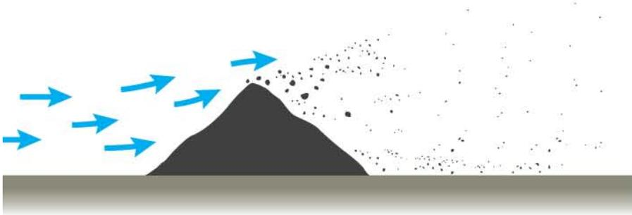
Ветер ускоряется вверх по склону отвала и уносит пыль с поверхности. Более мелкие частицы поднимаются в воздух, более крупные отскакивают и катятся вниз по другой стороне отвала и по земле. С конструкциями для защиты от ветра смонтированными перед отвалом, скорость ветра снижается и только очень мелкие частицы выветриваются. Некоторые из них летят, другие катятся вниз по земле.
