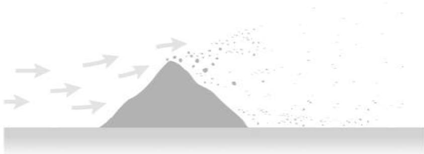
O vento acelera no lado da pilha erodindo poeira da superfície. Partículas menores sobem para o ar, as maiores voam para o outro lado e ao longo do chão. Com um wind fence na frente da pilha, a velocidade do vento é reduzida para que apenas as partículas menores se soltem. Algumas destas sobem para o ar e outras caem ao longo do chão.
